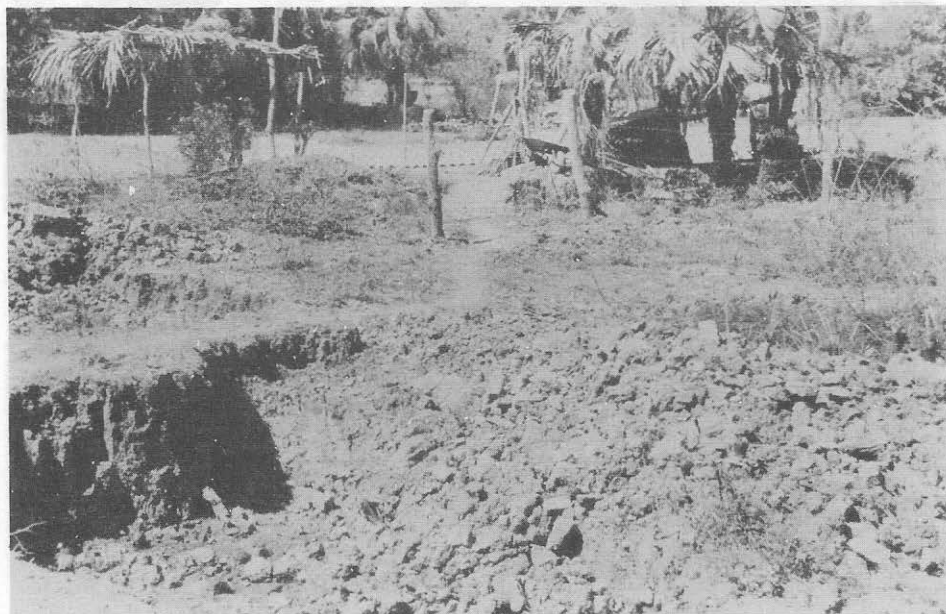
1. Local de coleta da argila. A escavação é feita com alavanca para a retirada dos torrões.
