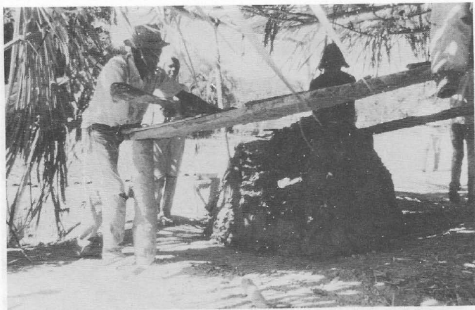
4. Vista da oficina. Nota-se no centro parte do monte de argila já preparada para utilização ladeado por duas bancas onde são feitas as telhas.
