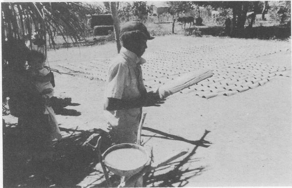
11. A telha já moldada é alisada com a mão molhada. Personalizando a peça o artesão desenha a letra N na face externa da telha.
