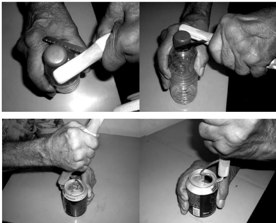
Dispositivo facilita a abertura de latas, potes e garrafas por portadores de artrite reumatoide
