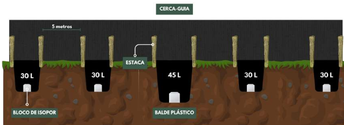
Figura 2. Esquema representativo das armadilhas de interceptação e queda ( pitfalls ).
