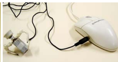
Figura 14 – Acionador confeccionado com botão liga/desliga de computador
