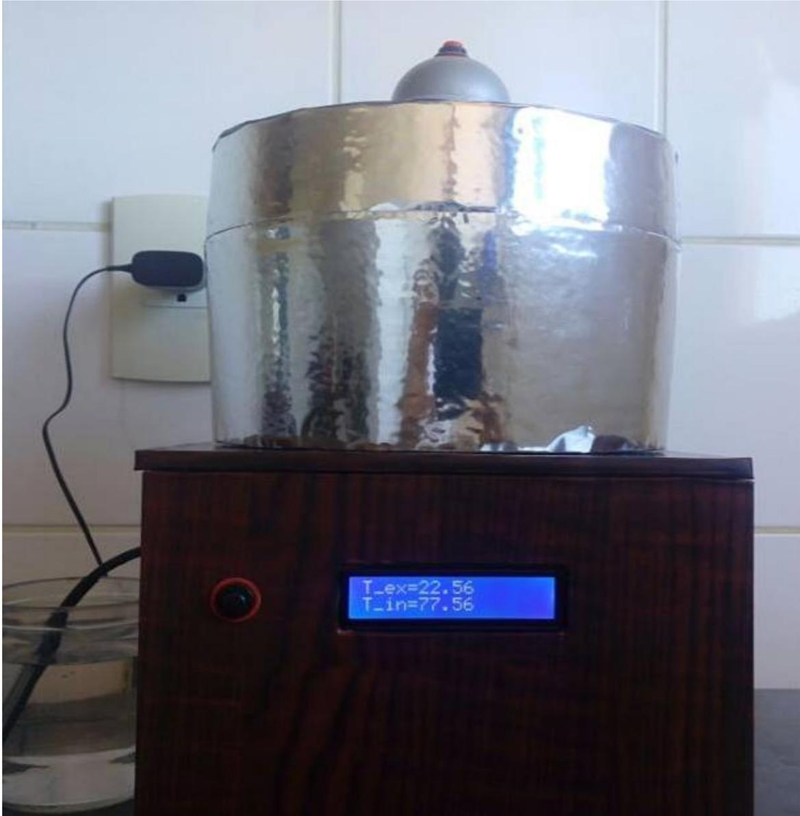
O calorímetro desenvolvido apresentou capacidade calorífica de  $16,14 (\pm 0,02)$  cal. $^{\circ}\text{C}^{-1}$  (Tabela 1).
