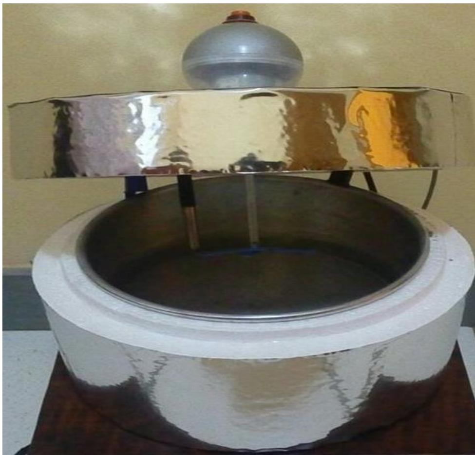
O agitador foi construído a partir de um motor de corrente contínua, modelo RF-300C, com tensão de operação 5,9 V, diâmetro de 25 mm, altura do corpo do motor (sem o eixo) de 14 mm, eixo de 6 mm e peso de 0,0214 Kg. Sua hélice é composta de polietileno com uma haste do mesmo material fixada no motor para formar um sistema livre para girar.
