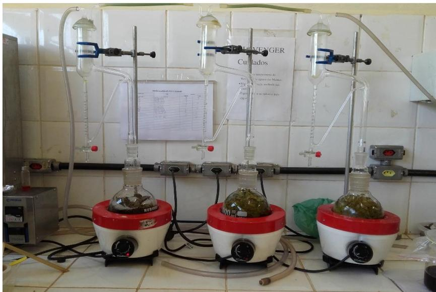
**Figura 3** – Clevenger Adaptado, utilizado para extração dos óleos essenciais.
