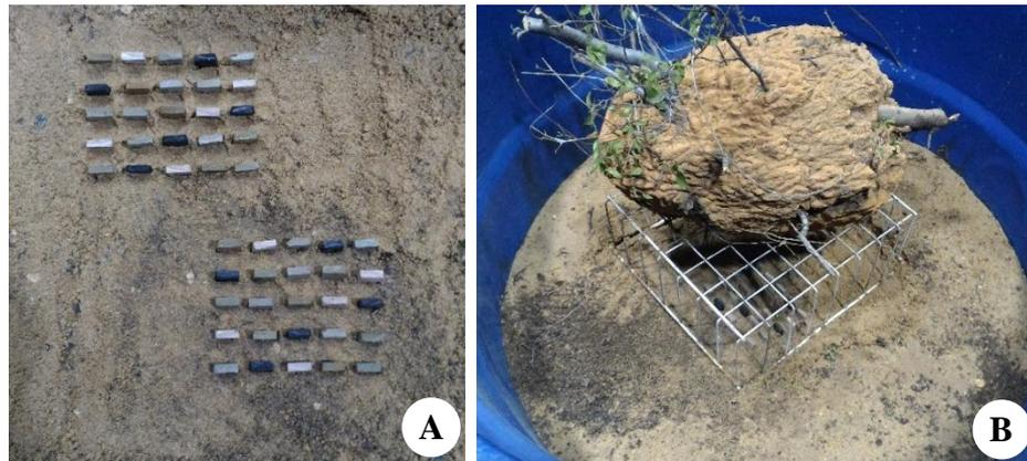
Legenda: (A): corpos de prova dispostos de forma aleatório na areia umida; (B): experimento montado.
