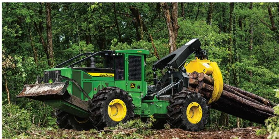
Figura 1. Trator florestal skidder 4 x 4 utilizado para o baldeio de árvores.
