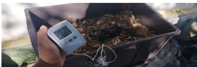
Figura 14 - Medição da temperatura e umidade das caixas digestoras usando o termo higrômetro digital
