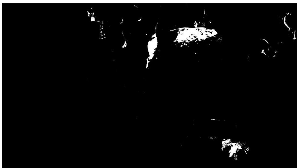
Figura 3 – Resultado da aplicação da técnica de subtração do fundo após processamento de um quadro do vídeo em linguagem *Python*.
