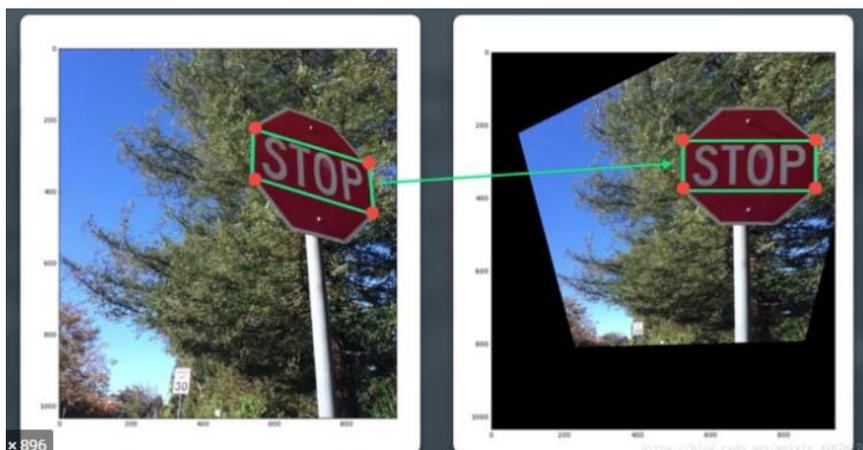
Figura 2 – Demonstração de distorção com OpenCv. Medium.com (2020).
