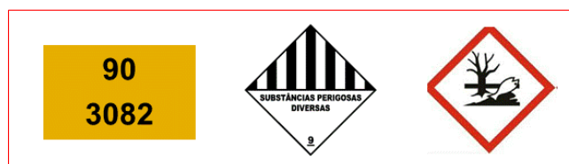
FIGURA 1 - Sinalização de Segurança para os Veículos do Transportador: Painel de Segurança, Rótulo de Risco e Símbolo de Risco
