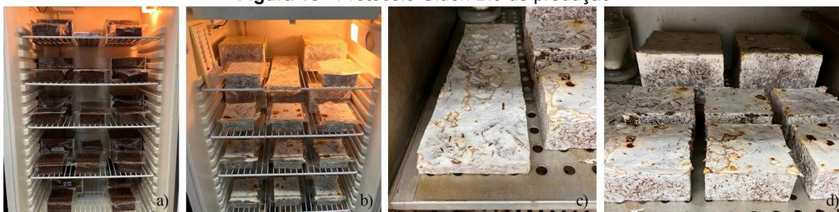
Micocompósitos são retirados das fôrmas de PETG e aquecidos em estufa de secagem e esterilização. Fonte: imagens do autor (2023)
