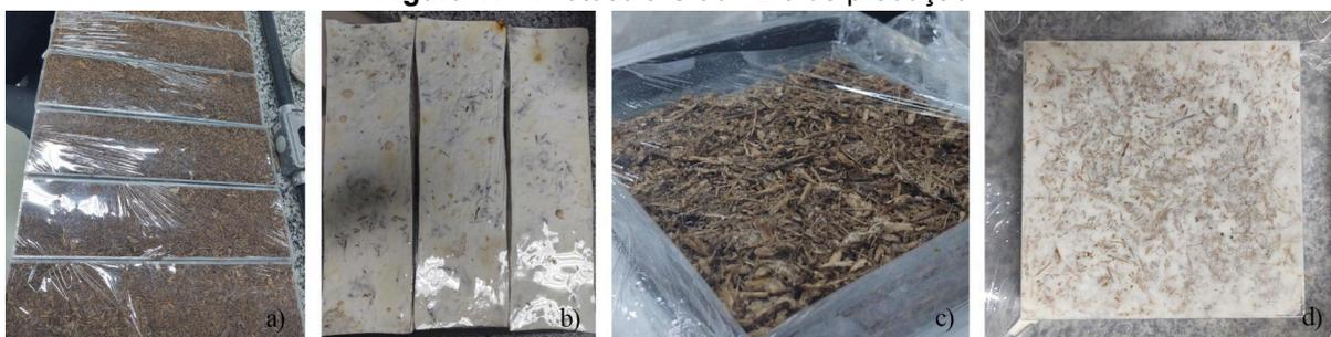
Formagem: a) ; c) Mistura inserida em formas de PETG, fechadas com insulfilm e armazenadas em estufa de cultivo ou BOD. b) ; d) Micocompósito pronto para desformagem. Fonte: imagens do autor (2023)
