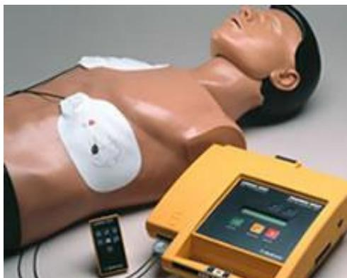
Depois de ligado, ele dá instruções verbais para o procedimento a ser executado. Identifica automaticamente o ritmo cardíaco normal e as arritmias potencialmente letais (Fibrilação Ventricular- FV e Taquicardia Ventricular- TV). Além de diagnosticar, ele é capaz de tratá-las, através da desfibrilação (aplicação de corrente elétrica que interrompe a arritmia, fazendo com que o coração retome o ciclo cardíaco normal)<sup>10</sup>.
