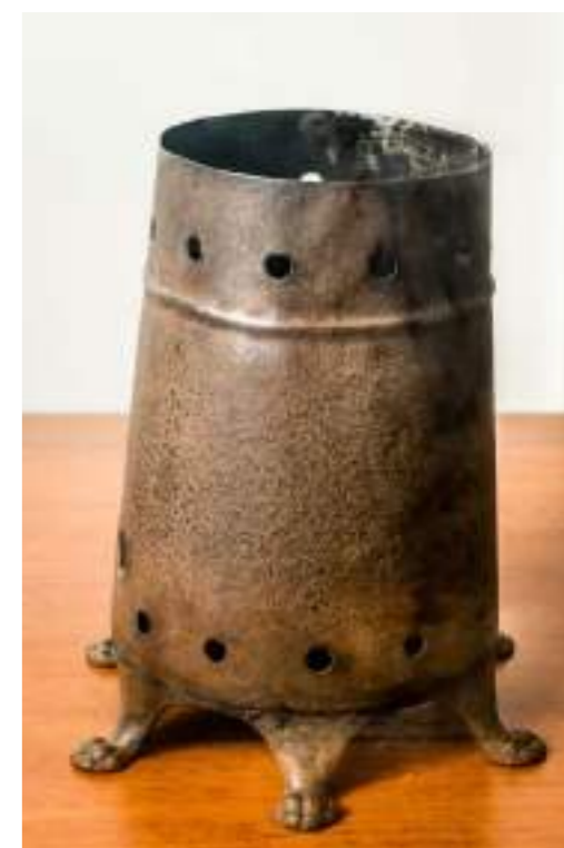
Fogareiro à querosene (Séc. XIX/XX): a partir da chama alimentada à querosene, o fogareiro era útil na confecção de próteses odontológicas. Confeccionado em metal. Houve perda parcial da grelha, devido a corrosão do tempo.
