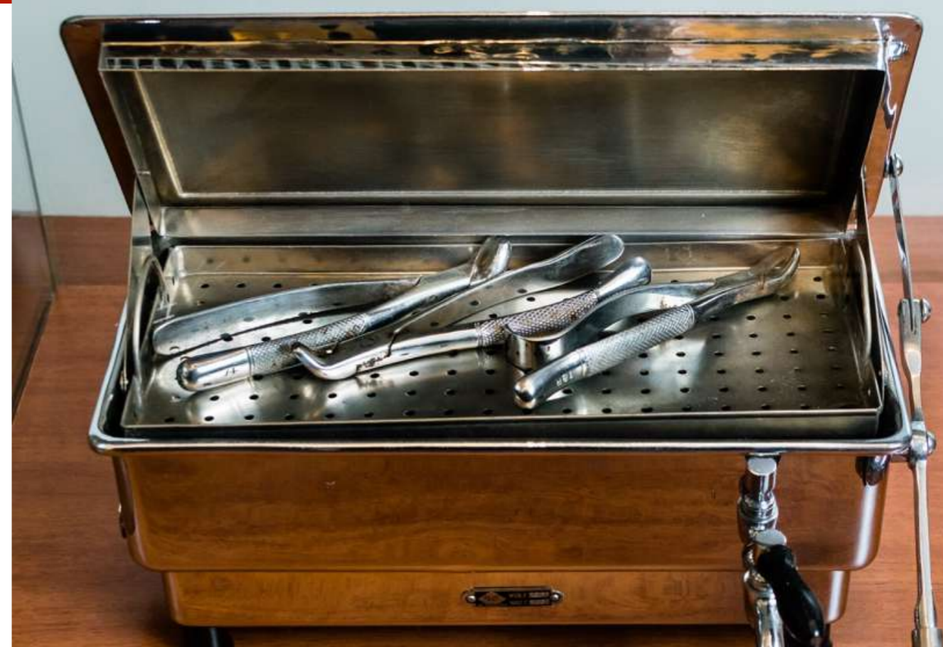
Esterilizador de calor úmido a eletricidade (Séc. XIX/XX): Método físico para esterilização de instrumentais odontológicos. A partir do uso de eletricidade, a água do recipiente entrava em ebulição e os materiais colocados sob a bandeja eram esterilizados por vapor de água. Confeccionado em metal, pegador emborrachado.
