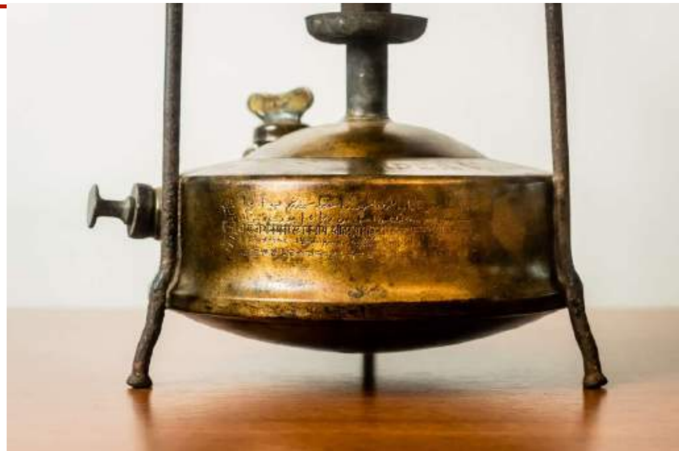
Detalhe fogareiro com banho-maria (Séc. XIX/XX): Método físico para esterilização de instrumentais odontológicos. A partir da chama do fogareiro localizado abaixo do recipiente, a água entrava em ebulição e os materiais colocados dentro da rede eram esterilizados pelo vapor de água. Confeccionado em metal.
