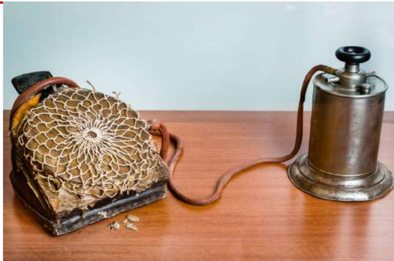
Fole ou compressor (Séc XIX/XX): compressor de ar mecânico. Para fazer o motor de baixa rotação funcionar, o dentista deveria acionar o pedal de acordo com a velocidade desejada de rotação. Pedal confeccionado em couro e estrutura em metal.
