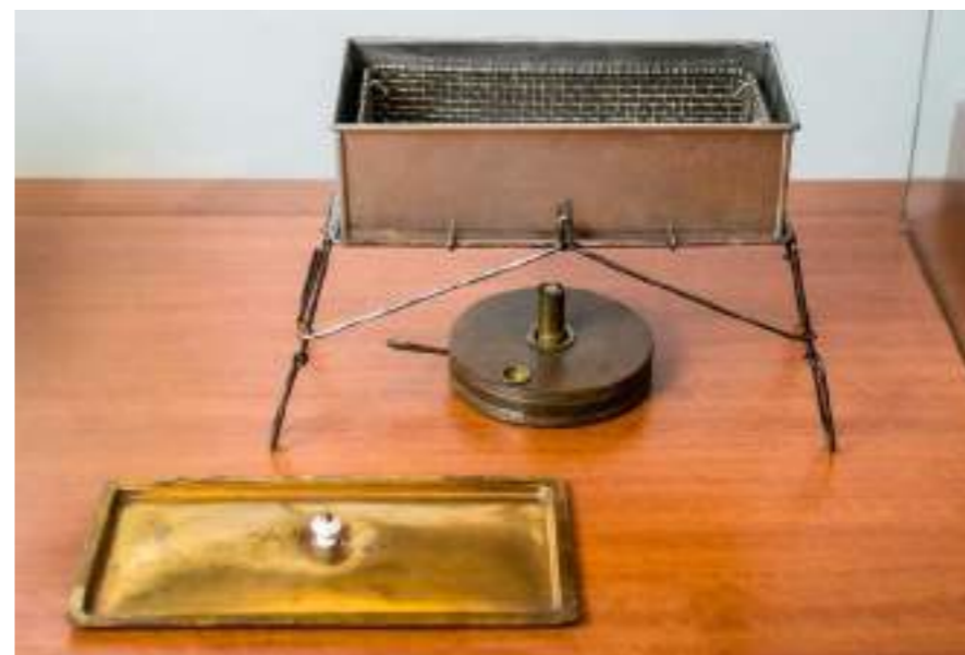
Fogareiro com banho-maria (Séc. XIX/XX): Método físico para esterilização de instrumentais odontológicos. A partir da chama do fogareiro localizado abaixo do recipiente, a água entrava em ebulição e os materiais colocados dentro da rede eram esterilizados pelo vapor de água. Confeccionado em metal.
