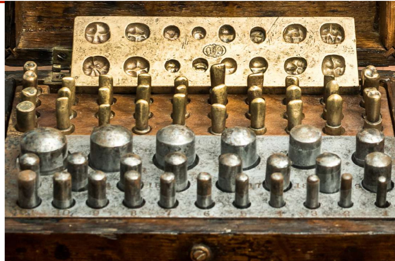
Estojo de estampador com punções (Séc. XX): Conjunto composto por 32 (trinta e duas) punções cilíndricas com extremidades na forma de cada um dos elementos dentais humanos. Caixa em madeira, e punções em metal.
