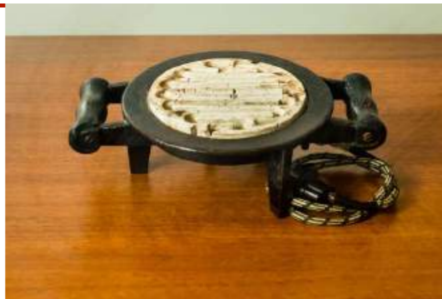
Fogareiro elétrico (Séc. XX): Usando a eletricidade, era útil para a confecção de próteses odontológicas. Base confeccionada em ferro e cerâmica.
