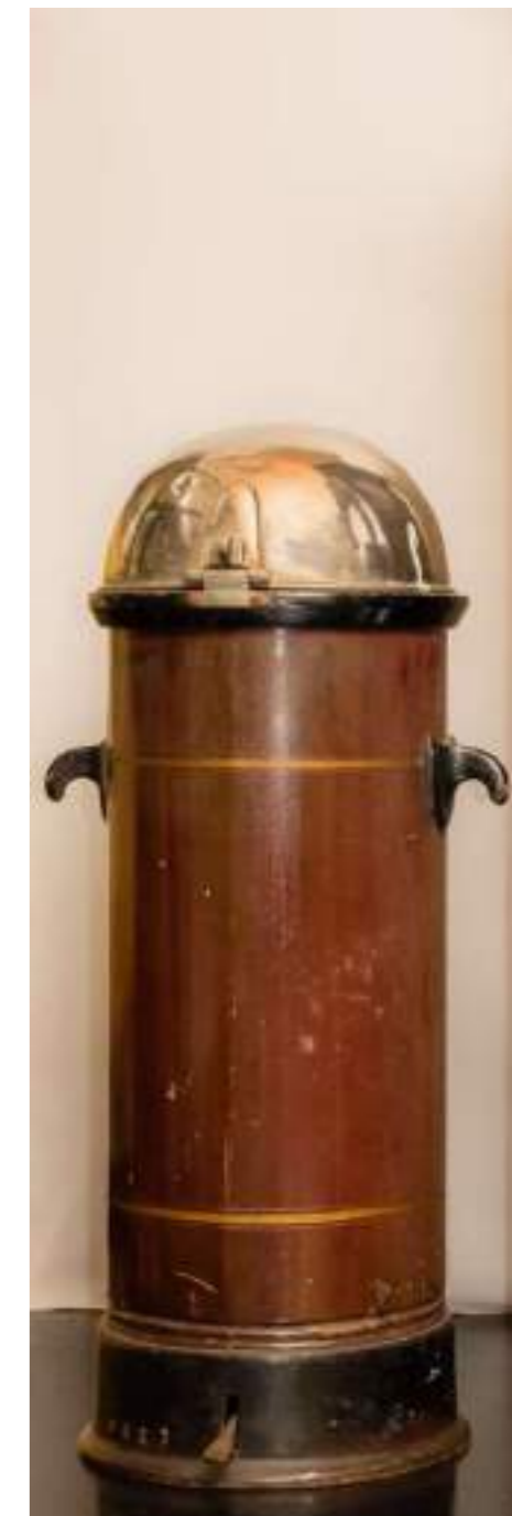
Fogareiro elétrico (Séc. XX): Usando a eletricidade, era útil para a confecção de próteses odontológicas. Base confeccionada em ferro e cerâmica.
