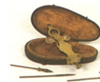
Microscópio de uma lente datado de 1700. Este tipo de instrumento foi popularizado por Leeuwenhoek, no final do século XVII.
