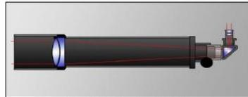
Figura 1: Modelo de um telescópio refrator.
