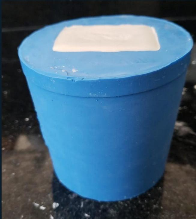
*Molde em borracha de silicone a partir do modelo impresso*
